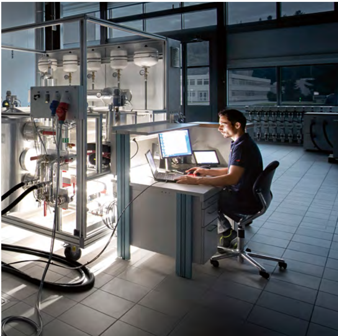
Prüfstand für Wärmepumpen mit Klimakammer
