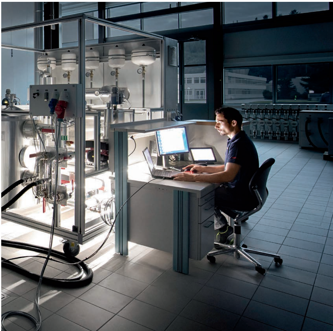
Prüfstand für Wärmepumpen mit Klimakammer
